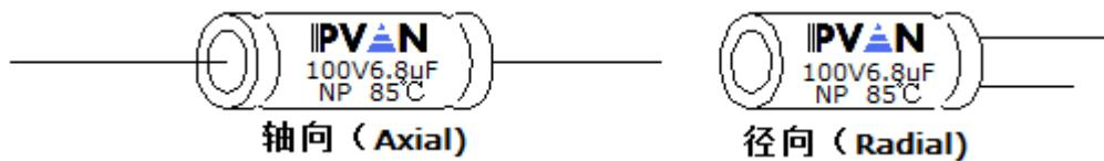
导线直径(mm), ± 0.05 mm (部分卧式电容本体直径为 12 ø, 导线直径有可能是 0.6 mm)
